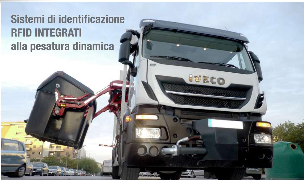
Sistema di identificazione RFID: le antenne vengono installate sull'allestimento in prossimità della zona di svuotamento o sul pettine del voltacontenitori posteriore. Queste antenne trasmettono le informazioni relative al cassonetto identificato, associando il dato di peso al tag identificativo.
