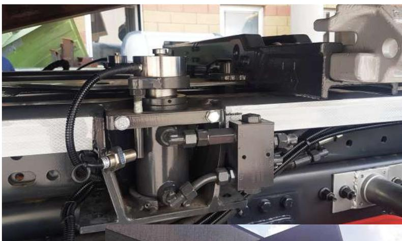
Il sistema prevede l'installazione di quattro pistoni oleodinamici sui quali poggiano le celle di carico che, sollevandosi, rilevano il peso certificato del materiale contenuto nel cassone scarrabile.
